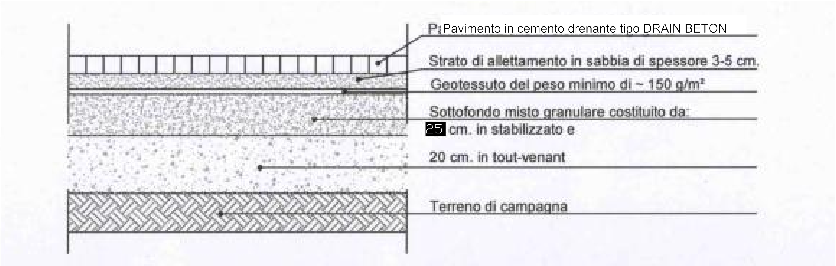
DETTAGLIO COSTRUTTIVO PAVIMENTAZIONE PARCHEGGIO
